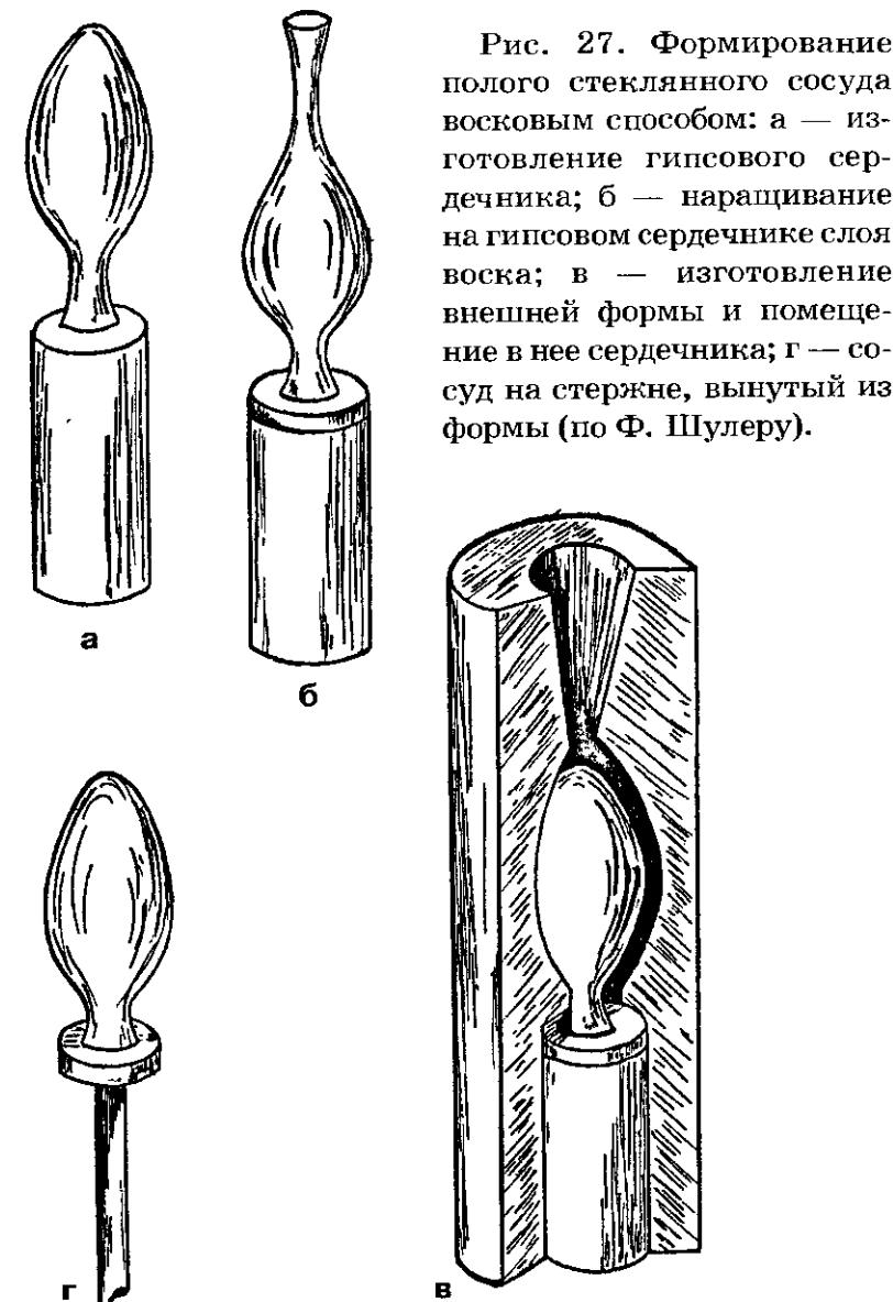
Рис. 27. Формирование полого стеклянного сосуда восковым способом: а — изготовление гипсового сердечника; б — наращивание на гипсовом сердечнике слоя воска; в — изготовление внешней формы и помещение в нее сердечника; г — сосуд на стержне, вынутый из формы (по Ф. Шулеру).
