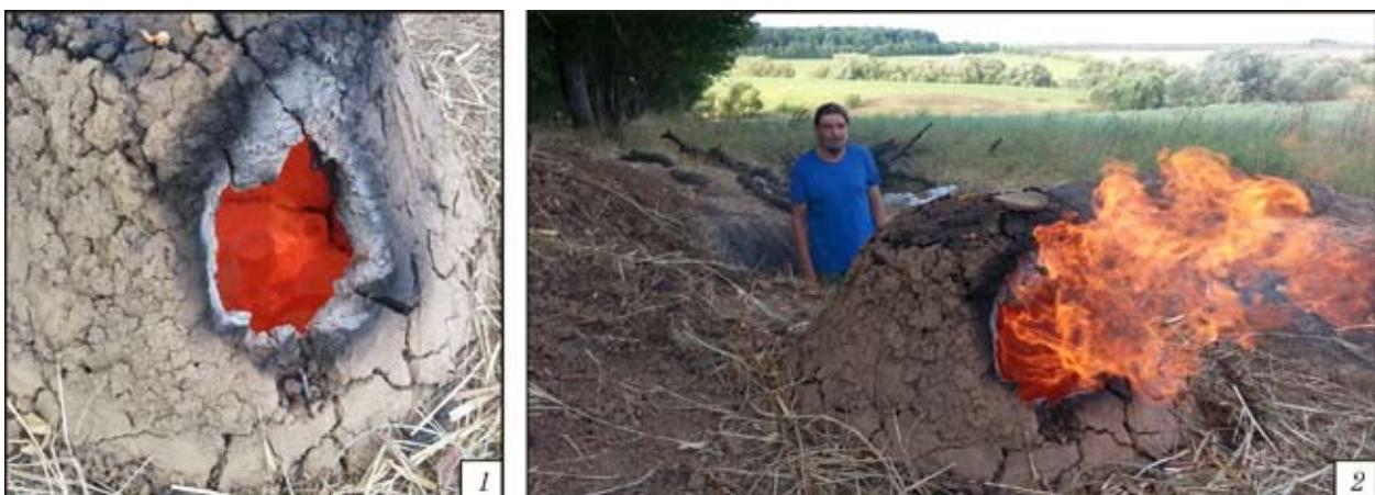
Рис. 13. Робота горна під час випалювання глиняного посуду, зразків скла та скляної шихти
